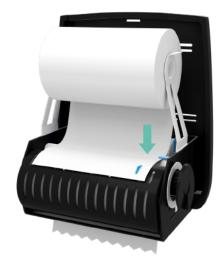
Encaja la toalla del nuevo rollo en la pestaña azul del rodillo del dispensador, así el producto nuevo comenzará a utilizarse automáticamente una vez que se agote el rollo anterior.
